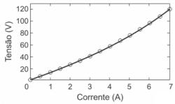
Após a análise do gráfico, ele concluiu que a tensão em função da corrente é dada pela equação  $V = 10 i + i^2$ .
