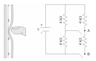
Qual é a resistência equivalente no circuito provocada por um toque que fecha o circuito no ponto A?
