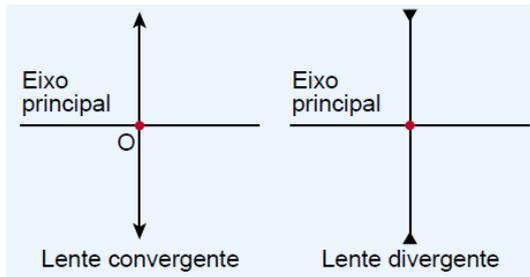
O centro óptico (O) de uma lente esférica é o ponto do eixo principal por onde passa um raio luminoso que não sofre desvio angular.
