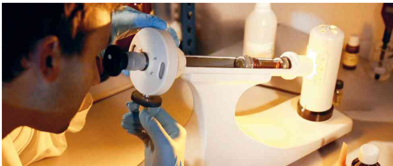
Técnico utilizando um polarímetro para determinar a atividade óptica de óleos essenciais.
