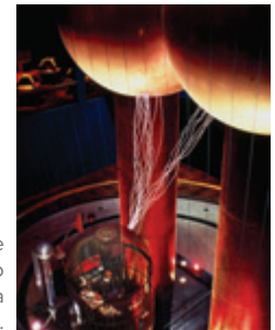
A gaiola de Faraday impede que a pessoa sofra algum dano devido à intensa faísca elétrica do aparelho.
