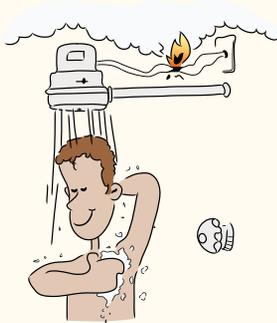
O superaquecimento da fiação, devido a esse aumento da corrente elétrica, pode ocasionar incêndios, que seriam evitados instalando-se fusíveis e disjuntores que interrompem essa corrente, quando a mesma atinge um valor acima do especificado nesses dispositivos de proteção.
