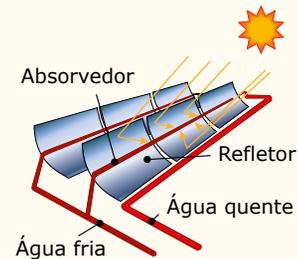
Para baratear a fabricação do espelho concentrador, uma empresa utiliza quatro longas "tiras" de espelhos montadas paralelamente ao tubo absorvedor, conforme mostra a figura seguinte.
