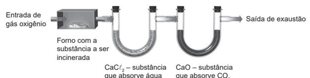
A substância incinerada tinha uma massa de 10,0 g e se encontrava em um forno com abertura para entrada de gás oxigênio. Nessa situação, entrou em combustão completa produzindo água,  $H_2O$ , e dióxido de carbono,  $CO_2$ , ambos no estado gasoso. Essas substâncias, ao passarem pelos tubos em formato de U, foram incorporadas às massas desses tubos, conforme representado na seguinte tabela:
