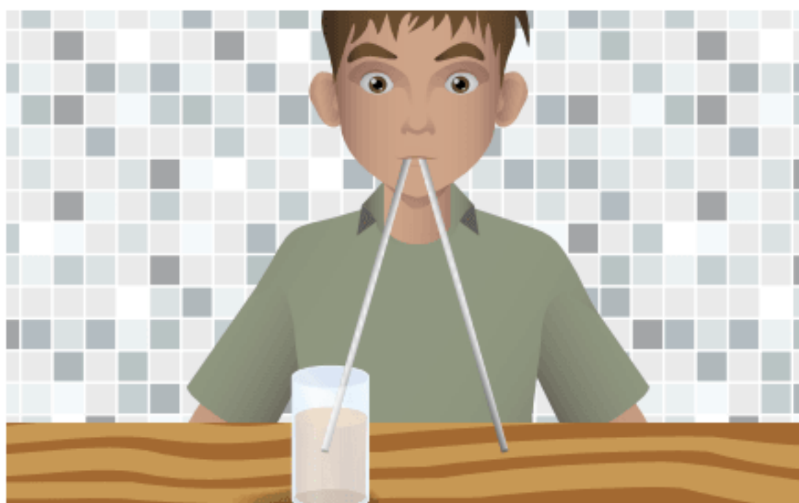
Fig. 10 Ao utilizarmos dois canudos, um dentro do copo, em contato com o líquido, e outro fora do copo, não conseguimos sugar o líquido, já que fica impossível criar a diferença de pressão. Na boca, teríamos sempre ar com pressão atmosférica por causa do canudo que está fora do copo.
