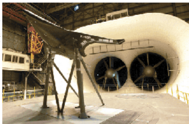
Fig. 2 Aeronave em um túnel de vento, que é utilizado para a determinação de parâmetros aerodinâmicos nos projetos de aeronaves.
