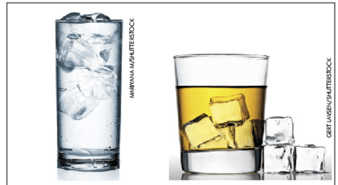
Fig. 25 O gelo ( d_{\text{gelo}} \approx 0,9 \text{ g/cm}^3 ) flutua em água ( d_{\text{água}} = 1 \text{ g/cm}^3 ), mas afunda em álcool ( d_{\text{álcool}} \approx 0,8 \text{ g/cm}^3 ).
