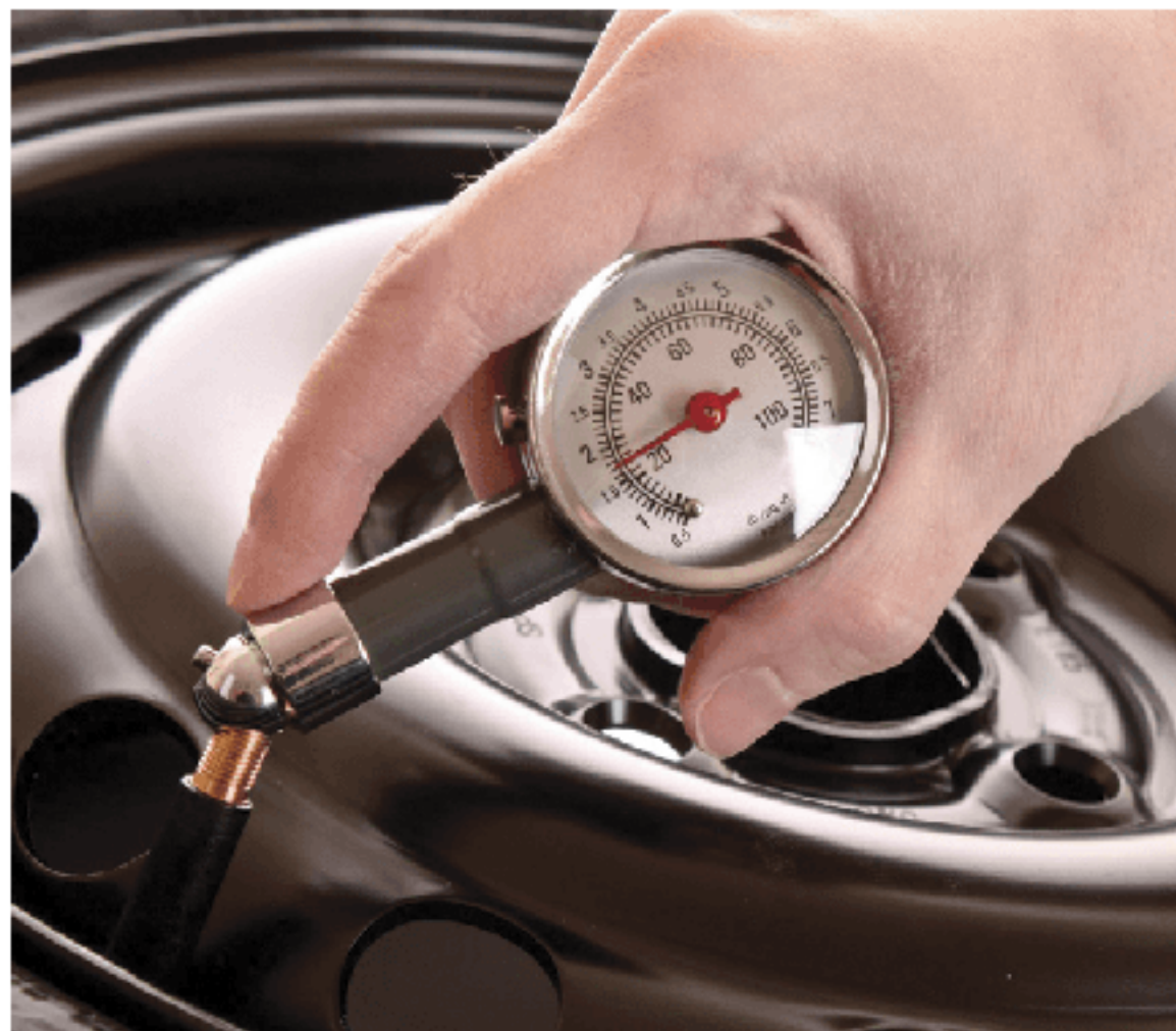
Fig. 7 Na calibragem de pneus, a pressão utilizada é a manométrica.
