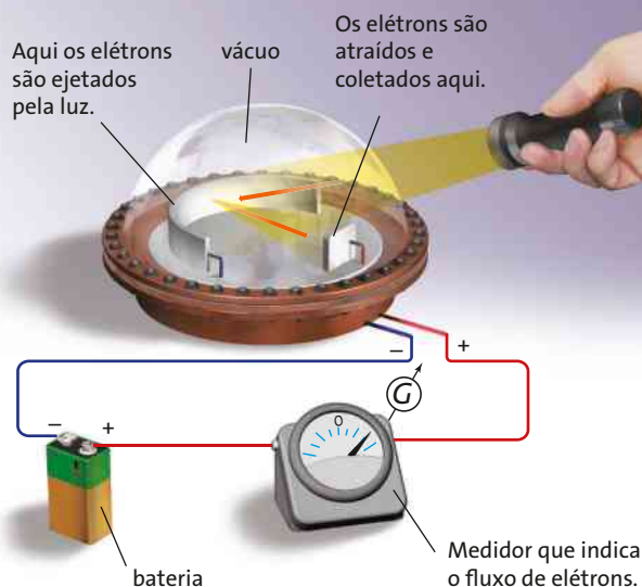
Figura 9.15 Representação (sem escala e em cores fantasia) do experimento do efeito fotoelétrico.
