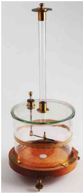
Figura 4.13 Modelo de balança de torção usada por Coulomb.
