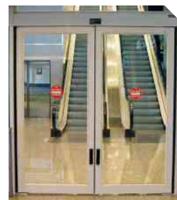
Figura a As portas automáticas utilizam células fotoelétricas. Elas são responsáveis por indicar a presença de um usuário.
