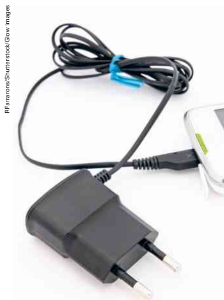
Figura 2.3 Os carregadores de celulares normalmente funcionam tanto em tomadas de 127 V como de 220 V.
