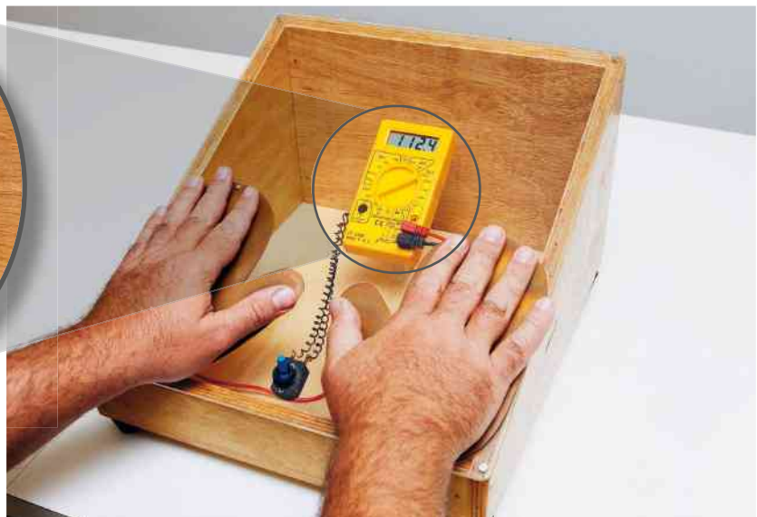
Figura 2.14 Arranjo experimental para a medida de resistência elétrica do corpo humano considerando diferentes pontos de contato.
