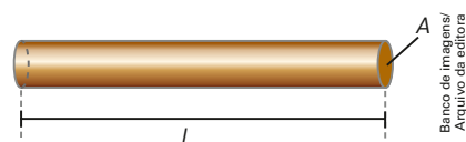
Figura 2.17 Representação de um fio homogêneo de comprimento L e área da seção transversal A .
