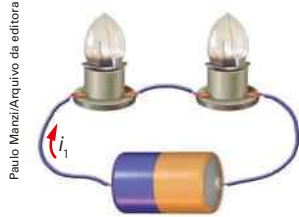
Figura 2.20 A corrente elétrica é a mesma nas duas lâmpadas associadas em série.
