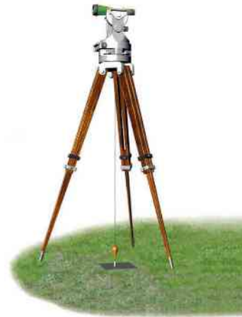
Teodolito, apoiado em tripé.
