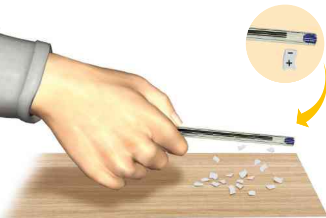
Figura 4.4 Atracção de um corpo neutro por um eletrizado.
