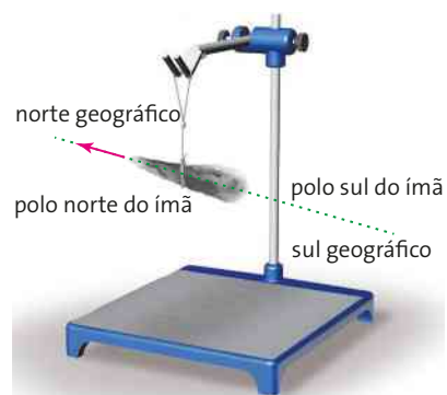
Figura 6.2 Representação esquemática do alinhamento natural de agulhas magnéticas segundo a direção geográfica norte-sul. Esse é o princípio básico do funcionamento de uma bússola.
