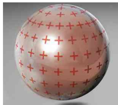
Figura 4.1 Esfera metálica com excesso de cargas elétricas distribuídas pela superfície externa.
