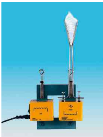
Figura 7.15 Este transformador aumenta 40 vezes a intensidade da tensão eficaz. A alta intensidade do campo entre as hastes provoca a ionização do ar. Isso resulta em descargas elétricas entre as hastes.
