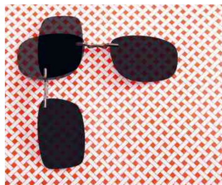
Figura 8.25 Observe que a superposição das lentes em diferentes direções ocasiona o ofuscamento da luz.
