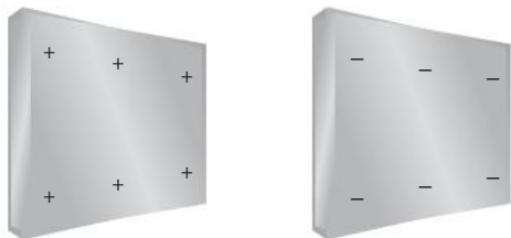
Placas condutoras separadas por um material dielétrico.
