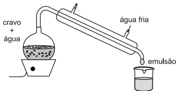
O processo de obtenção do eugenol no laboratório químico é relativamente simples, conforme indicado no aparato experimental representado na figura.
