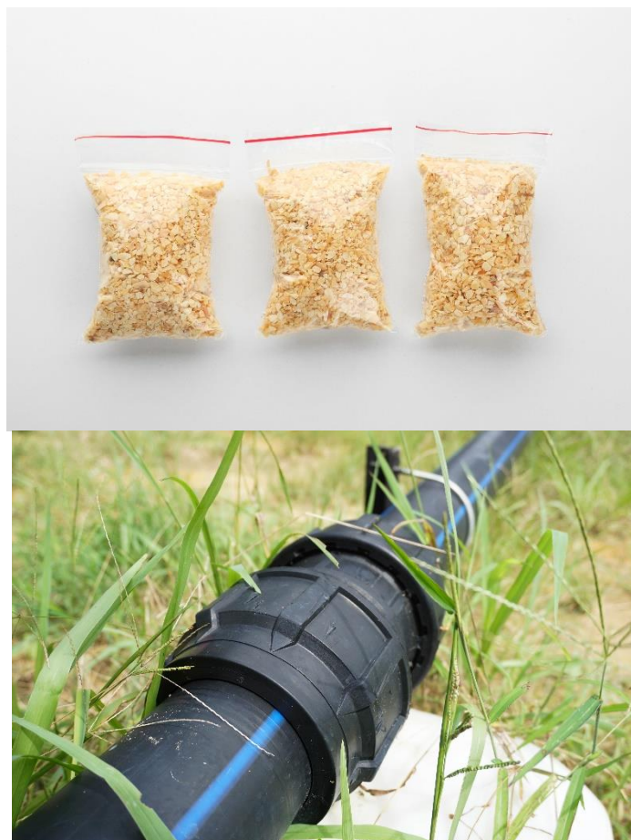
Figura 8: Sacos plásticos feitos com polietileno de baixa densidade (LDPE) e tubo feito com polietileno de alta densidade (HDPE). Fonte: Shutterstock
