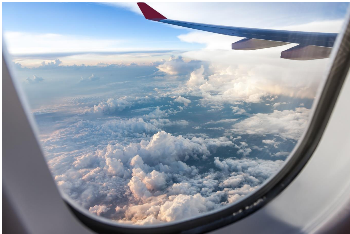
Figura 50: As janelas e o para-brisa dos aviões é constituído de fibra de vidro ou policarbonato
