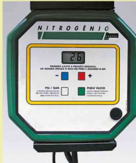
Equipamento usado para calibrar pneus com gás nitrogênio.
