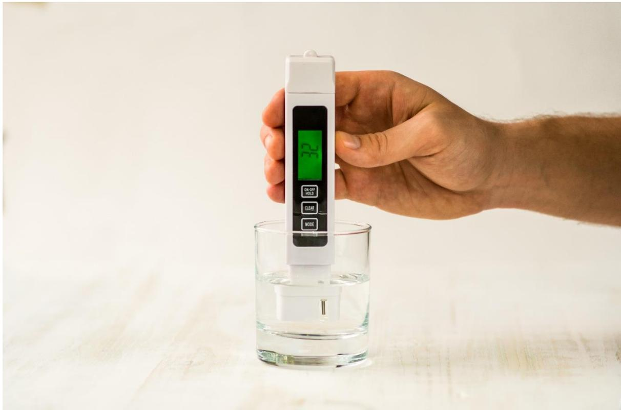
*Figura 1: Medidor de TDS em um copo de água mineral*
