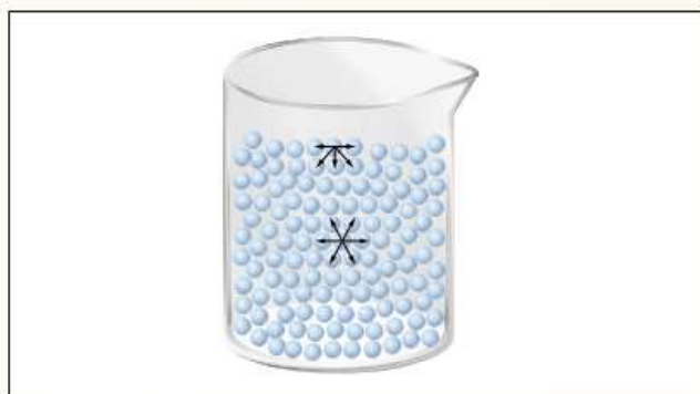
Forças intermoleculares agindo em uma molécula situada na camada superficial de um líquido e no interior do líquido.
