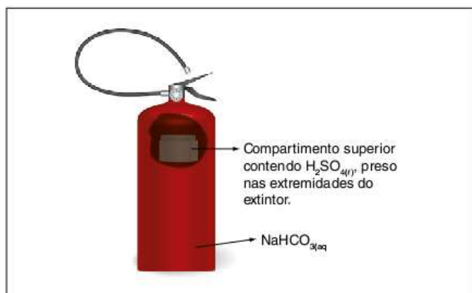
Fig. 5 Configuração simplificada de um extintor de incêndio.
