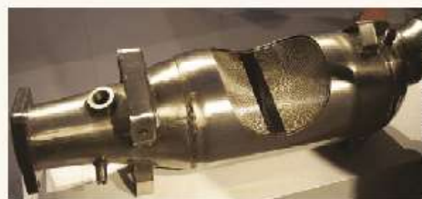
Fig. 12 Catalisador com corte lateral.
