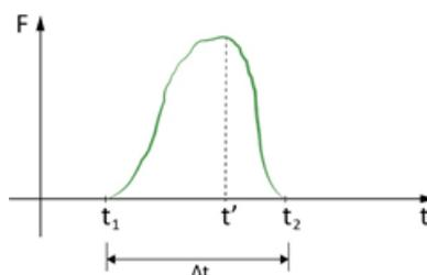
Figura 10: Gráfico da força impulsiva em função do tempo. De  $t_1$  a  $t'$  constitui a fase de deformação e de  $t'$  a  $t_2$  a fase de restituição.
