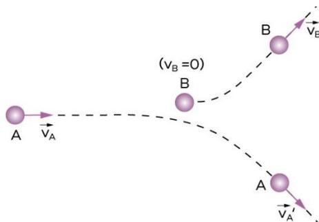
Figura 9: Devido à repulsão eletrostática, o próton, que estava em repouso, entra em movimento segundo a direção indicada, caracterizando uma colisão sem a necessidade de haver contato entre os corpos.
