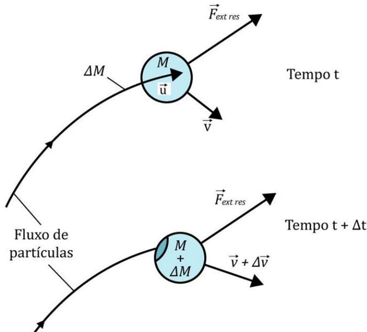
Figura 39: Partículas de um fluxo contínuo, com velocidade  $\vec{u}$ , sofrem colisões perfeitamente inelásticas com um corpo de massa  $M$  que possui velocidade  $\vec{v}$ . Nesse sistema, existe uma força externa resultante  $\vec{F}_{ext\ res}$  atuando sobre o corpo. A figura ilustra dois momentos do sistema:  $t$  e  $t + \Delta t$ .
