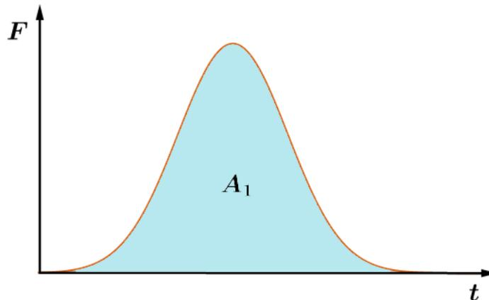
Figura 5: Gráfico da intensidade da força variando com o tempo. A área sombreada é numericamente igual ao módulo do impulso.
