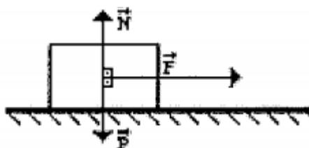
Aplica-se uma força ( $\vec{F}$ ) de intensidade constante  $10 \text{ N}$ , sempre na mesma direção e sentido, sobre um corpo, inicialmente em repouso, de massa  $2,0 \text{ kg}$ , localizado sobre uma superfície horizontal sem atrito. Sabendo-se que além da força mencionada atuam sobre o corpo somente o seu peso e a normal, calcule, em metros, o deslocamento escalar sofrido pelo corpo
