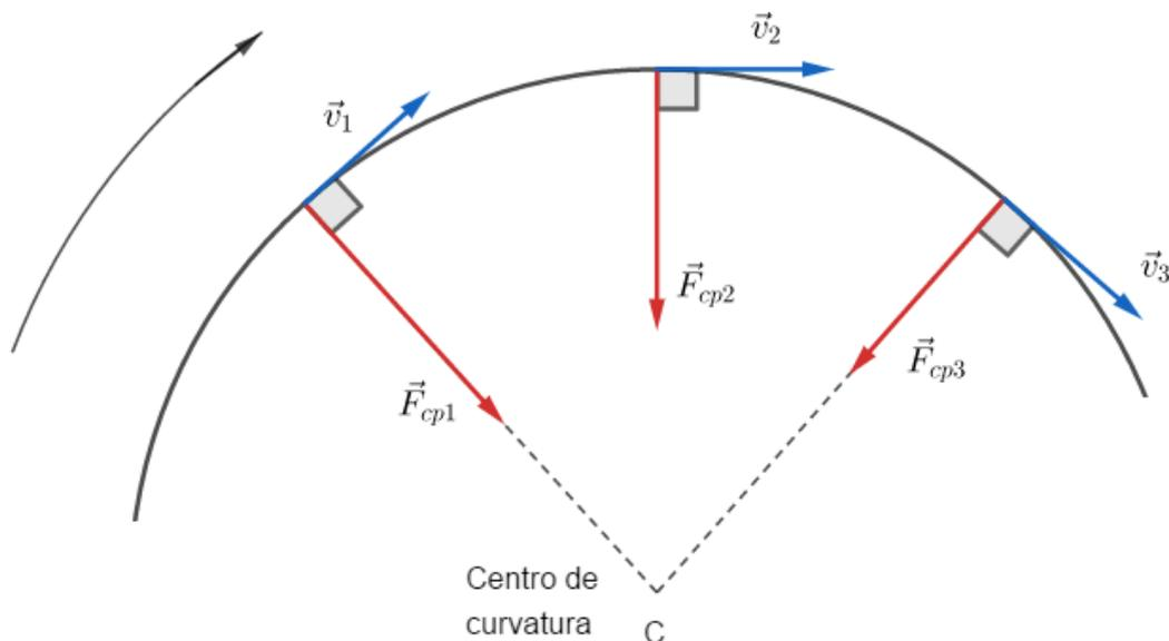
Figura 42: Representação dos vetores velocidade e força centrípeta.
