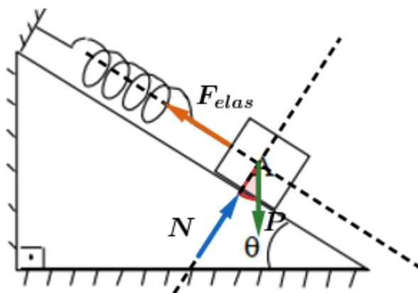
Se o sistema está em equilíbrio, então a projeção do peso na direção do plano inclinado é igual a força elástica. Portanto:
