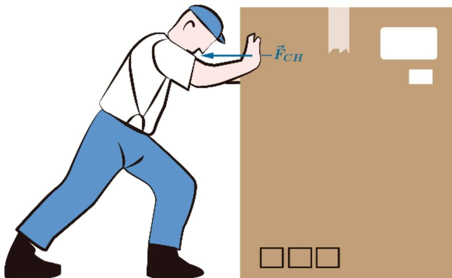
Figura 10: Reação do caixote aplicada no homem.
