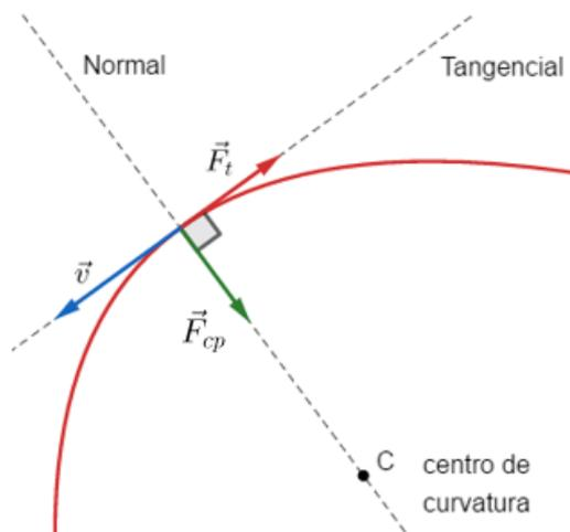
Figura 40: Velocidade e aceleração tangencial em sentidos opostos.
