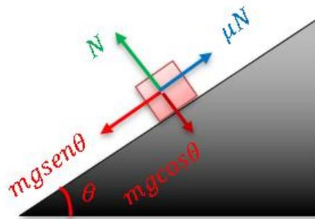
Na direção normal ao plano, a força normal é igual a componente do peso  $mg\cos\theta$ .
