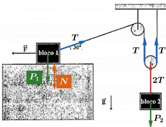
Na direção horizontal, a aceleração do bloco 1 é dada por:
