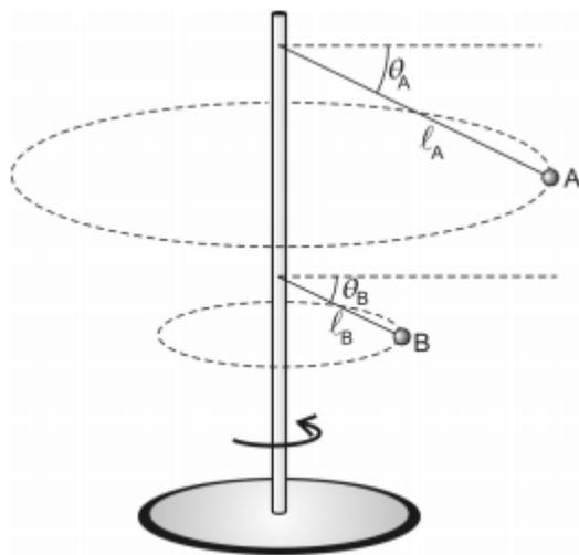
A e B giram em sincronia com a haste, com velocidades escalares constantes  $v_A$  e  $v_B$ , e fazem com a direção horizontal ângulos  $\theta_A$  e  $\theta_B$ , respectivamente.
