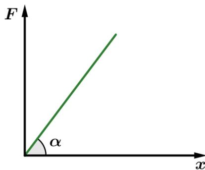
Figura 27: Gráfico da força elástica em função da deformação na mola.
