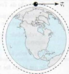
Fig. 31 Lançado com a velocidade cósmica primeira \vec{v}_1 , o satélite entrou em órbita circular próximo à superfície da Terra.
