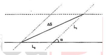
Podemos determinar  $\Delta S$  em função de  $L_1$  e  $L_2$  através da lei dos cossenos
