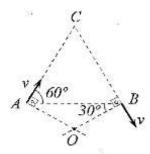
Chamaremos de l o comprimento dos lados do triângulo d a distância entre o ponto C e o centro instantâneo de rotação O.
