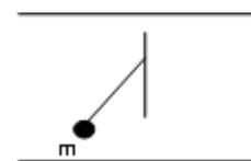
**79 - (ITA-92)** Na figura abaixo, a massa esférica  $M$  pende de um fio de comprimento  $L$ , mas está solicitada para a esquerda por uma força  $F$  que mantém a massa apoiada contra uma parede vertical  $P$ , sem atrito. Determine os valores de  $F$  e de  $R$  (reação da parede) (O raio da esfera  $\ll L$ ).
