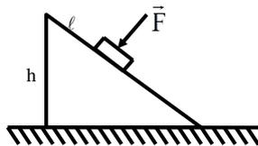
**74 - (ITA-93)** Um corpo de peso  $P$  desliza sobre uma superfície de comprimento  $\ell$ , inclinada com relação a horizontal de um ângulo  $\alpha$ . O coeficiente de atrito cinético entre o corpo e a superfície é  $\mu$  e a velocidade inicial do corpo é igual a zero. Quanto tempo demora o corpo para alcançar o final da superfície inclinada?
