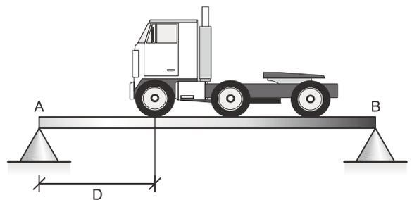
Desprezando-se o peso da viga, para que a reação vertical do apoio A seja o dobro da reação vertical no apoio B, a distância D entre o eixo dianteiro do caminhão e o apoio A deverá ser:
