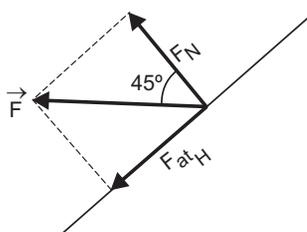
A força inclinada  $\vec{F}$  deve ser decomposta em uma componente normal à parede  $F_N$  e uma força de atrito horizontal  $F_{\text{at}_H}$ .
