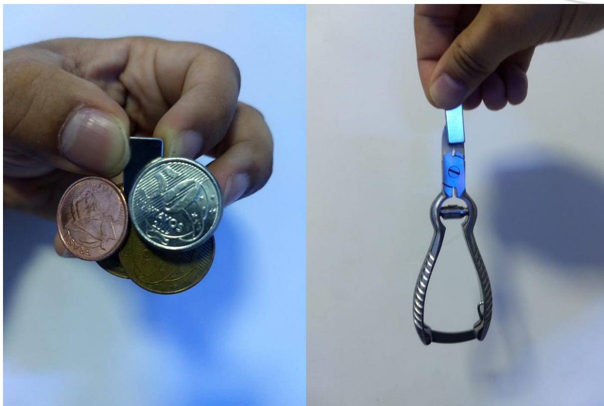
Figura 57: Um pequeno ímã de neodímio é capaz de suspender objetos de ferro ou aço muito maiores que o próprio ímã
