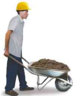
Figura 10.20 A força que o operador aplica é menor do que o peso que o carrinho transporta.
