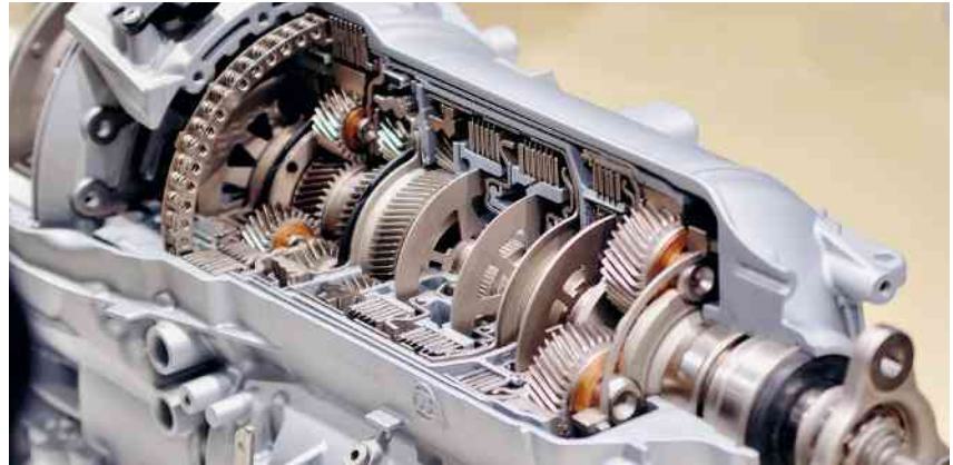
Figura 4.35 Seção transversal do câmbio de um automóvel. Nesse equipamento, a transmissão de movimento circular ocorre por meio de engrenagens.
