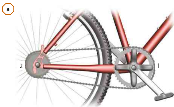
Figura a Representação, sem escala e em cores fantasia, da coroa e da catraca em uma bicicleta.
