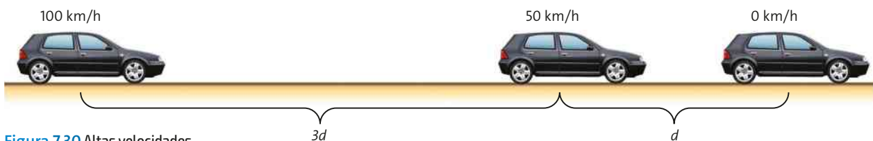
Figura 7.30 Altas velocidades atingidas em estradas exigem do motorista mais atenção em razão do maior espaço necessário para a frenagem. Representação sem escala e em cores fantasia.
