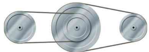
Figura 4.37 Associação mista de polias, com o emprego de duas correias para transmitir movimento.
