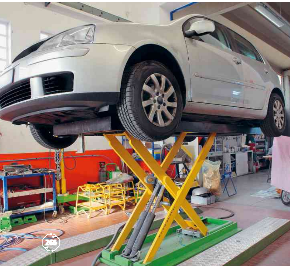
Figura 11.16 No elevador hidráulico, o acréscimo de pressão devido ao peso do carro é equilibrado pela força F_1 .
