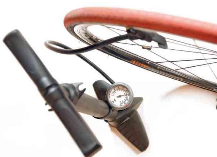
Figura 11.10 Manômetro utilizado para medir a pressão em um pneu de bicicleta.
