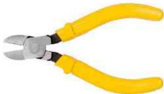
Figura 10.14 Alicates: o braço potente é bem maior que o resistente.
