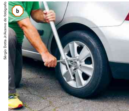
Figura 8.26 Aumentando-se o comprimento da haste da chave, aumenta-se o torque na porca a ser desatarraxada.
