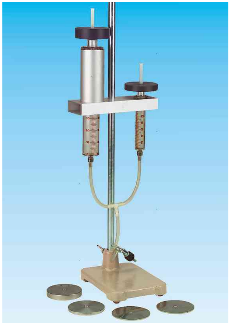
Figura 11.19 Arranjo experimental que exemplifica o princípio de funcionamento de uma prensa hidráulica. Para manter o sistema em equilíbrio, quanto maior a área das seringas, maior o número de arruelas.
