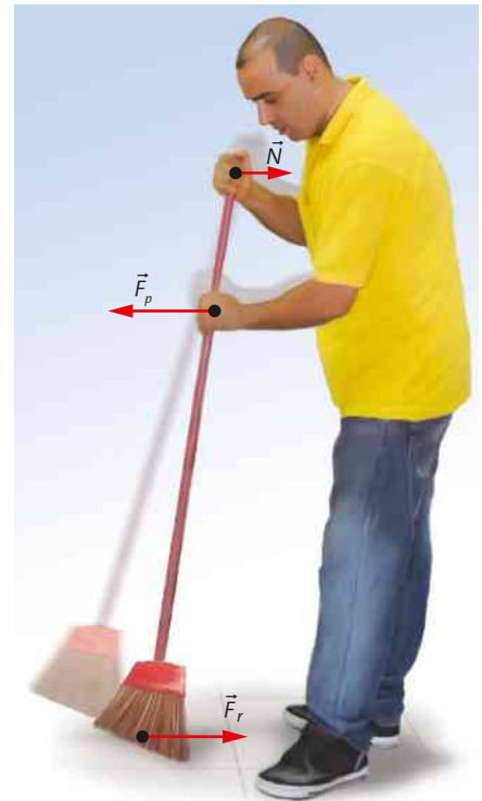
Figura 10.22 A vassoura e a representação das forças que nela agem durante sua operação. A mão que está na extremidade superior faz o papel de pivô.
