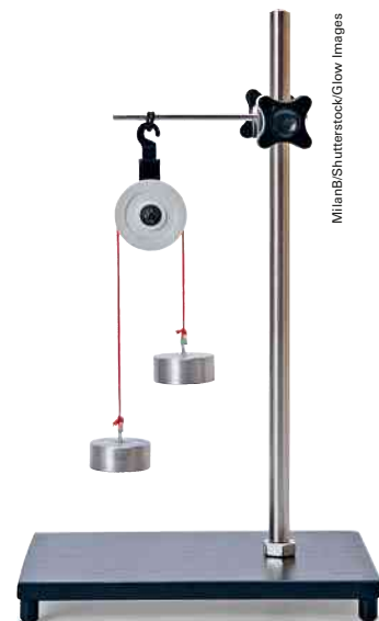
Figura 4.31 Um tipo de polia bastante comum; todos os seus pontos têm a mesma velocidade angular.
