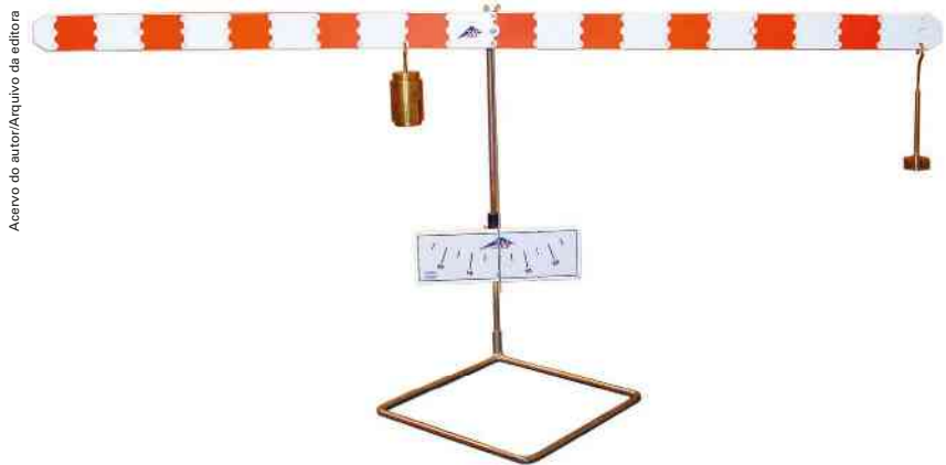
Figura 10.11 Barra em equilíbrio sob a ação de dois pesos diferentes e a força aplicada pelo apoio central.
