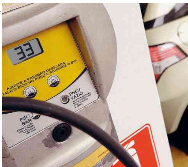
Figura 11.9 Manômetro utilizado para verificar a calibração de pneus de carro. A pressão lida no mostrador é igual a 33 psi.
