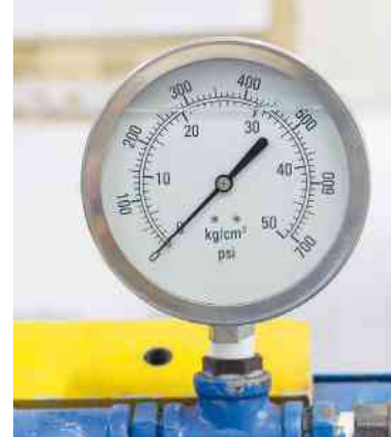
Figura 11.7 O manômetro é o instrumento com que se mede a pressão de fluidos.
