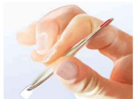
Figura 10.23 A pinça é uma alavanca interpotente.
