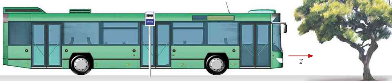
Figura 5.21 A aceleração \vec{a} do ônibus é resultado da interação das rodas propulsoras com o solo.
