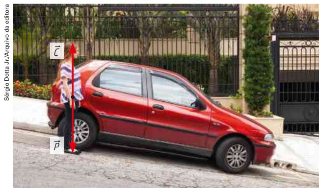
Figura 5.6 A força peso \vec{P} (atração) e a força de contato \vec{C} (força aplicada pela rampa na pessoa) se equilibram. Por facilidade, as forças \vec{P} e \vec{C} foram mostradas no mesmo ponto (centro de gravidade da pessoa).
