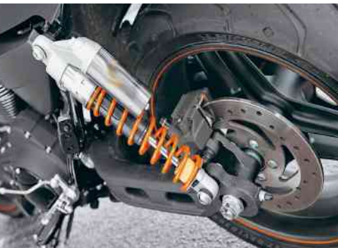
Figura 5.16 Mola dimensionada para compor a suspensão traseira de uma motocicleta.
