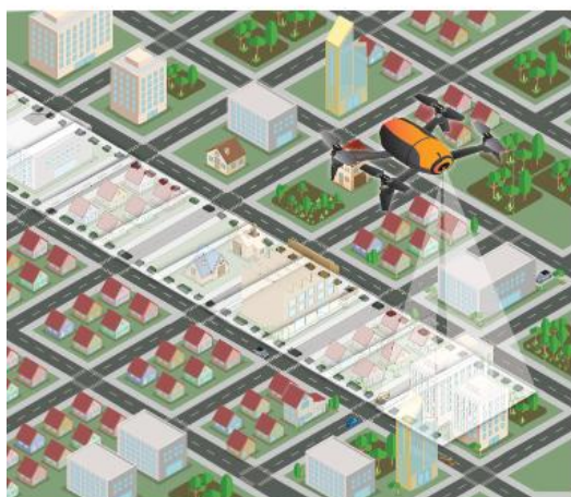
Fig. 20 Esquema de captura de aerofotos por meio de drones .
