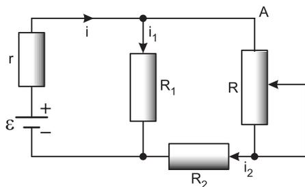
3. (ITA-99) – A força eletromotriz (f.e.m.) da bateria do circuito é de 12V. O potenciômetro possui uma resistência total de  $15\Omega$  e pode ser percorrido por uma corrente máxima de 3,0A.
