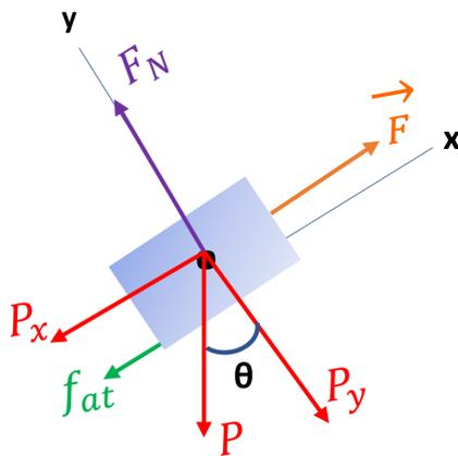
O diagrama de corpo livre mostra as forças atuando na pedra. A força  $F$  para cima é exercida pelos operários que puxam o bloco, a força peso ( $P$ ) para baixo é o próprio peso da pedra. Como ela está em um plano inclinado, decompomos a força peso nas direções horizontal ( $P_x$ ) e vertical ( $P_y$ ). A força normal ( $F_N$ ) atua para cima, e a força de atrito está direcionada para baixo, se opondo ao movimento.
