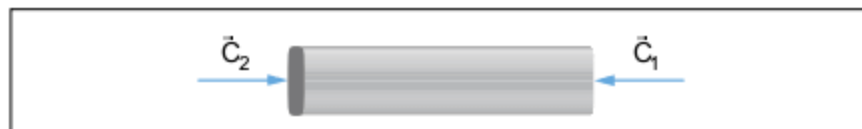
Fig. 23 Barra sujeita a compressão.
