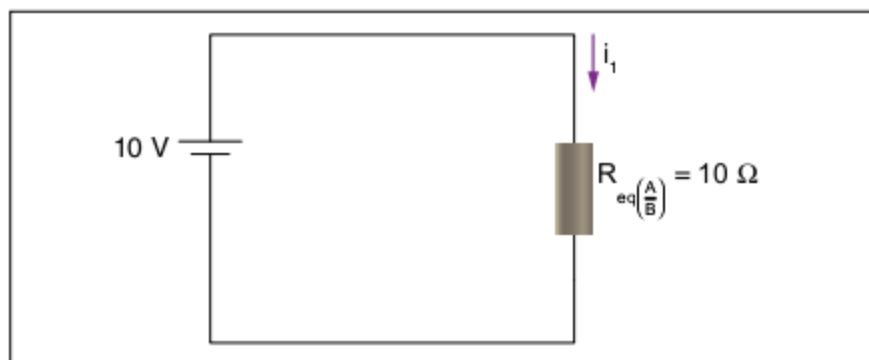
Fig. 26 Circuito equivalente final.
