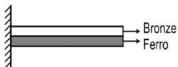
Nessa situação, a lâmina está plana e horizontal. A seguir, ela é aquecida por uma chama de gás. Após algum tempo de aquecimento, a forma assumida pela lâmina será mais adequadamente representada pela figura:
