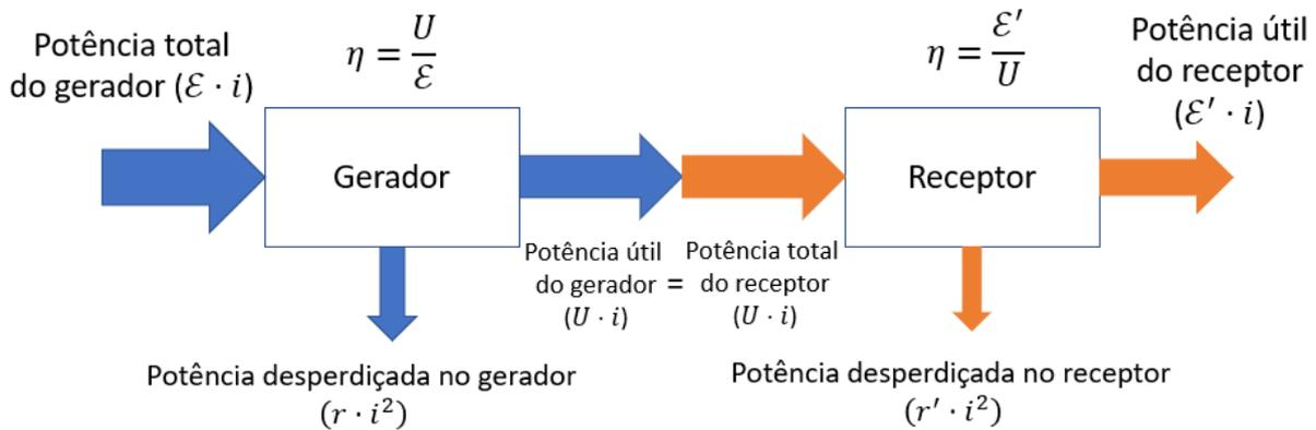
Figura 19: Esquema representativo das potências transferidas no circuito gerador-receptor.
