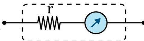
Figura 40: Ao inserir o galvanômetro no seu circuito, você deve levar em conta sua resistência interna.
