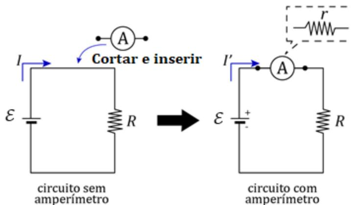
Figura 30: Aplicação de um amperímetro na medida da intensidade de corrente elétrica em um circuito simples.
