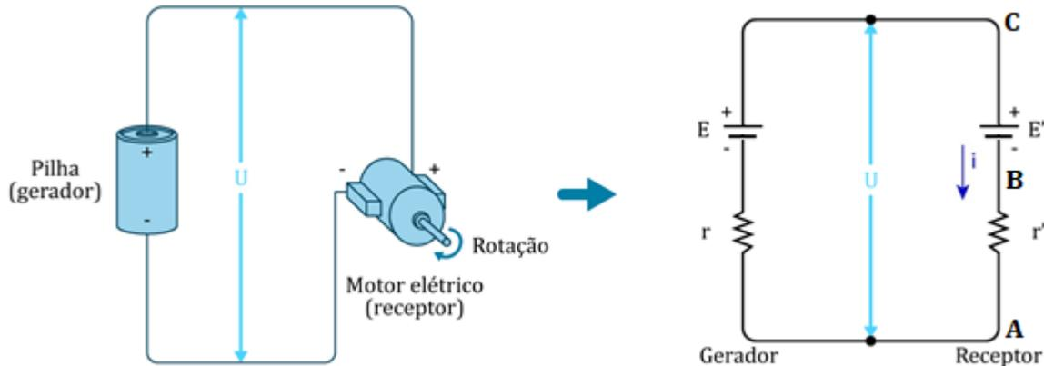
Figura 15: Esquema representativo de um receptor ligado a um gerador.
