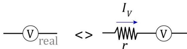
Figura 34: Quando o voltímetro é real, devemos considerar sua resistência interna no circuito.
