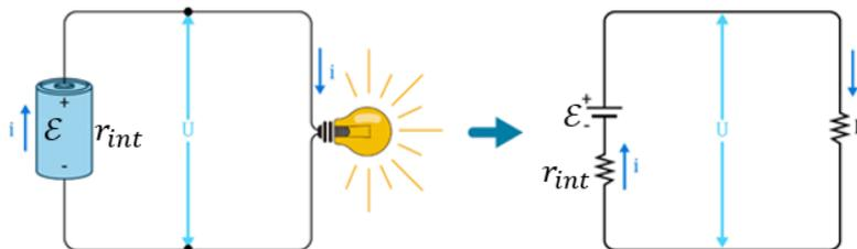
Figura 4: Gerador real ligado a uma lâmpada.
