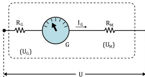
Figura 43: Voltímetro com resistor multiplicador.
