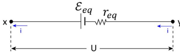
Figura 24: Representação do gerador equivalente.
