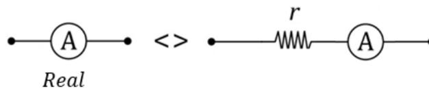
Figura 31: Ao inserir um amperímetro real no circuito, você deve levar em conta sua resistência interna.
