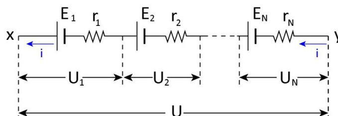
Figura 23: Associação de  $N$  geradores em série. Note que todos são percorridos pela mesma corrente elétrica.
