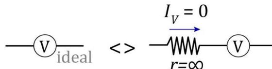
Figura 35: Quando o voltímetro é ideal, consideramos que a corrente não passa por ele.
