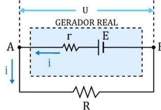
Figura 3: Representação de um gerador real onde a resistência interna é não nula.
