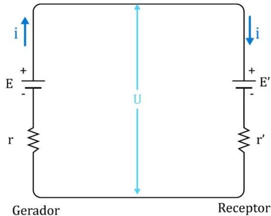
Figura 18: Receptor sendo alimentado por um gerador.
