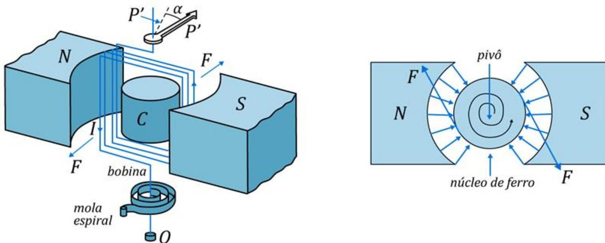
Figura 38: Representação das interações magnéticas no interior de um galvanômetro.
