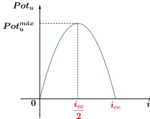
Figura 13: Gráfico da potência útil em função da corrente.
