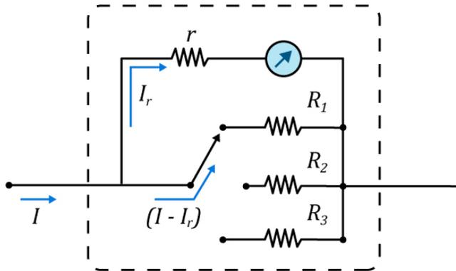
Figura 42: Esquema representativo para um amperímetro com vários fundos de escala.
