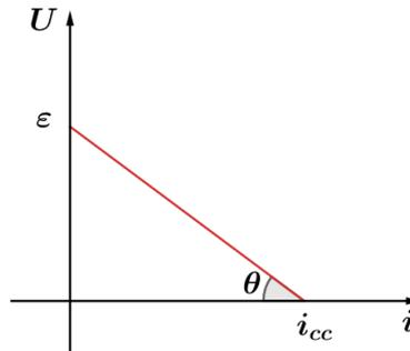
Figura 8: Curva característica de um gerador elétrico.
