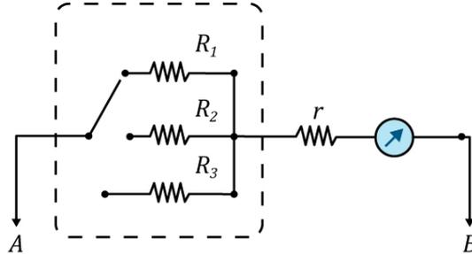
Figura 44: Representação de um voltímetro com vários fundos de escala.
