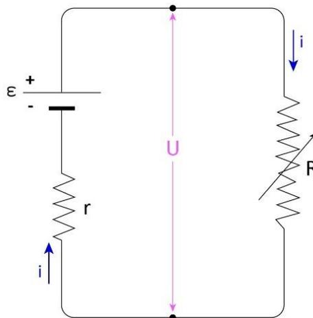
Figura 12: Gerador elétrico alimentando o reostato.
