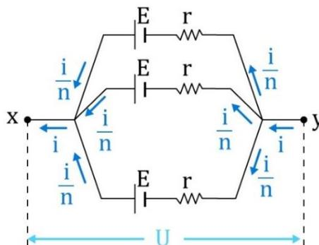
Figura 25: Conexão de  $n$  geradores idênticos em paralelo.
