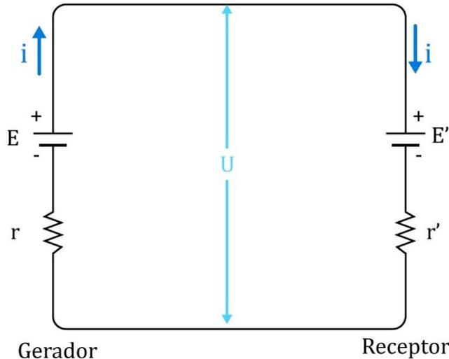
Figura 20: Circuito gerador-receptor.
