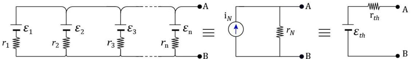
Figura 51: Utilização do método de Norton para determinação de gerador equivalente para uma associação em paralelo de geradores distintos.
