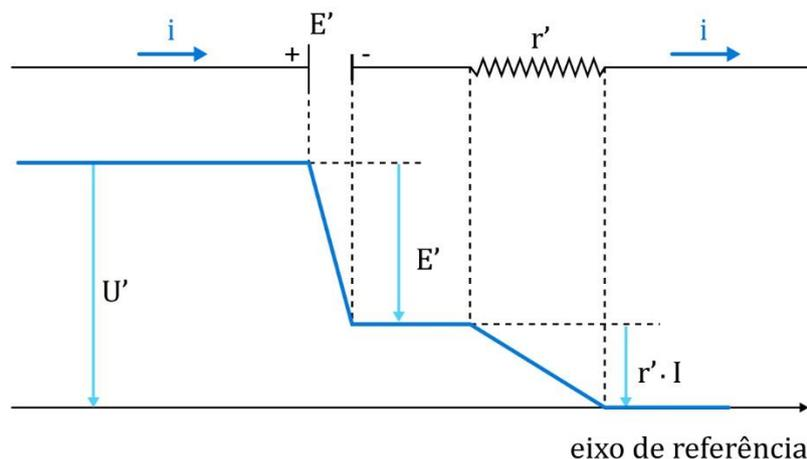
Figura 16: Diagrama representativo das quedas de potencial no receptor.
