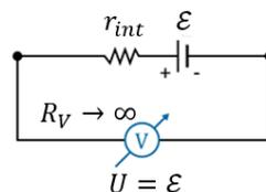
Figura 6: Gerador em aberto. Um voltímetro de resistência interna muito alta é capaz de medir com boa aproximação o valor da *fem*  $\mathcal{E}$ .
