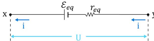
Figura 26: Representação do gerador equivalente para uma associação em paralelo.
