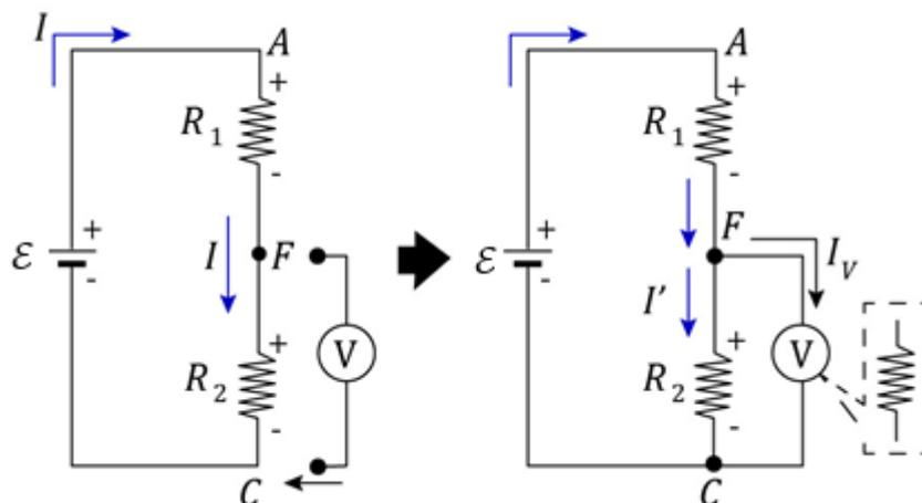
Figura 33: Voltímetro real em um circuito. Deve-se levar em conta a resistência interna do instrumento.
