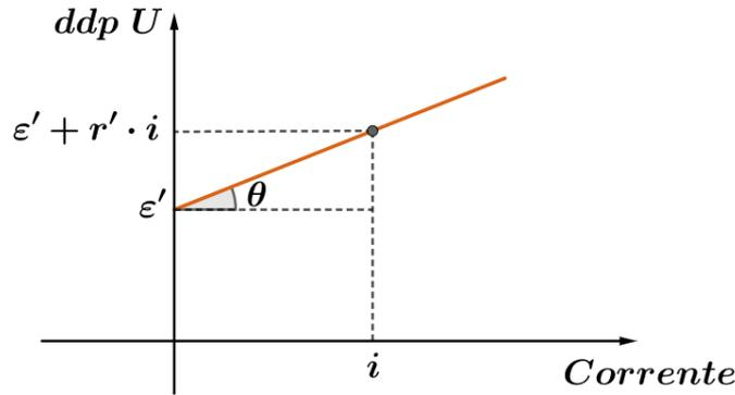
Figura 17: Curva característica de um receptor.
