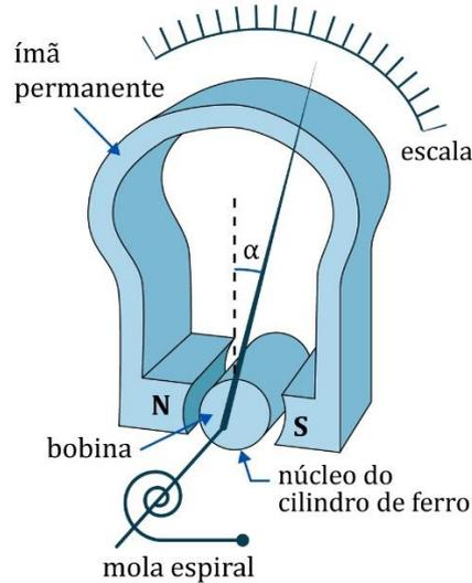
Figura 37: Esquema representativo de um galvanômetro.
