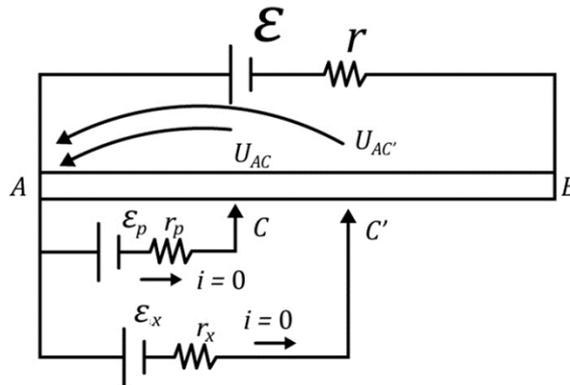
Figura 45: Esquema representativo para um potenciômetro de Poggendorff.
