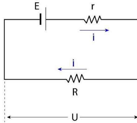
Figura 10: Circuito gerador e um único resistor.
