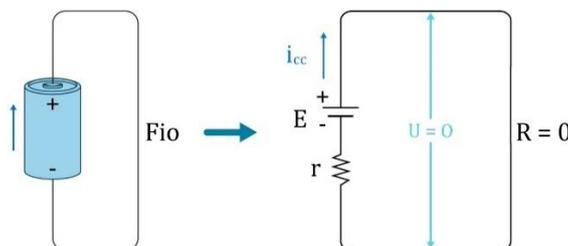
Figura 7: Representação de uma pilha em curto-circuito.
