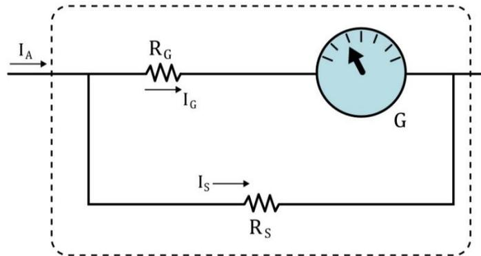
Figura 41: Desvio da corrente ao inserir o resistor shunt.
