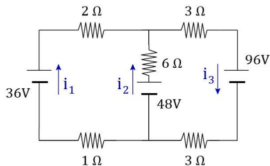
Figura 47: Circuito exemplo para a aplicação do teorema da superposição.
