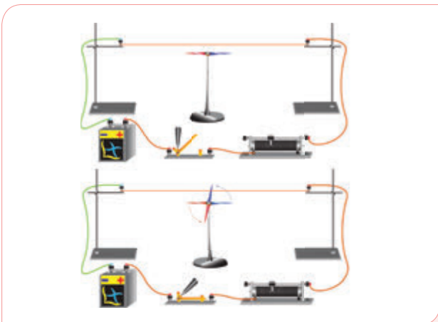
Campo magnético gerado por corrente elétrica. Na parte superior, o interruptor está aberto e, na parte inferior, o interruptor está fechado.
