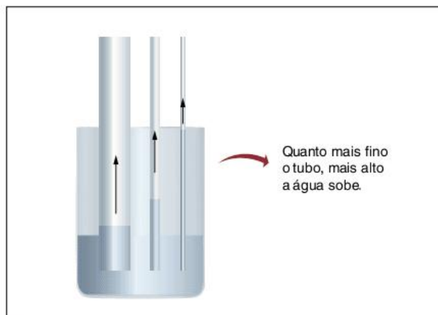
Fig. 9 O experimento mostra o efeito da capilaridade na subida do líquido.
