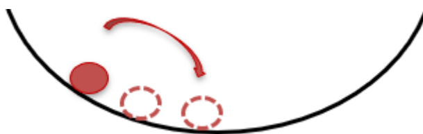
Figura 3: Ao ser perturbado, um corpo em equilíbrio estável tende a voltar para a posição original.
