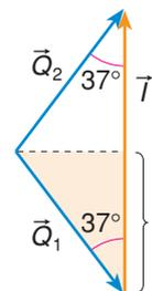
$$Q_1 = Q_2 = mv \Rightarrow Q_1 = Q_2 = 0,10 \cdot 15 \Rightarrow Q_1 = Q_2 = 1,5 \text{ kg} \cdot \text{m/s}$$
