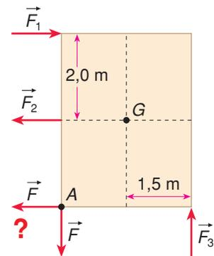
Se a força em A tiver direção **horizontal**, ela deve estar orientada **para a esquerda** (giro em sentido horário) e seu módulo deve ser:
