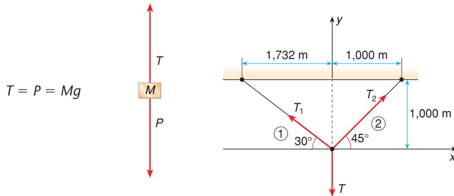
Das condições de equilíbrio nas direções vertical (projeções em  $y$ ) e horizontal (projeções em  $x$ ), obtemos:
