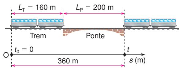
$$b) v = v_0 + \alpha t \Rightarrow v = 0 + 0,8 \cdot 30 \Rightarrow v = 24 \text{ m/s}$$
