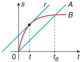
No instante  $t$  assinalado na figura, a reta  $r$  tangente à curva  $B$  é paralela à reta  $A$ . Significa que, nesse instante, a velocidade do trem  $B$  é igual à velocidade do trem  $A$ .
