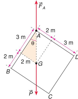
**P.480** a) O menor valor de  $\alpha$  corresponde ao prisma na iminência de tombar em torno de  $B$ . Nessas condições, o peso  $\vec{P}$  e a reação  $\vec{F}_N$  estão na mesma vertical, conforme a figura.
