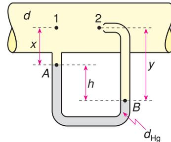
b)  $p_1 + \frac{d \cdot v_1^2}{2} = p_2 + \frac{d \cdot v_2^2}{2}$
