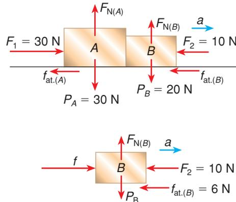
$$f_{\text{at.}(A)} = \mu \cdot F_{N(A)} \Rightarrow f_{\text{at.}(A)} = \mu \cdot P_A \Rightarrow f_{\text{at.}(A)} = 0,3 \cdot 30 \Rightarrow f_{\text{at.}(A)} = 9 \text{ N}$$
