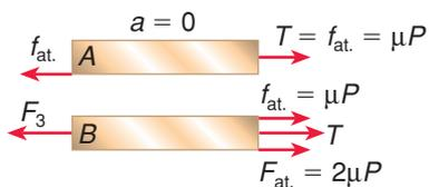
$$(B) F_3 = f_{\text{at.}} + T + F_{\text{at.}}$$
