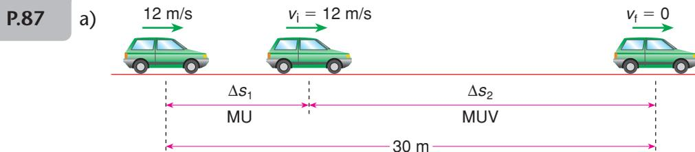
$$\Delta s_1 = v \cdot \Delta t \Rightarrow \Delta s_1 = 12 \text{ m/s} \cdot 0,5 \text{ s} \Rightarrow \Delta s_1 = 6 \text{ m}$$
