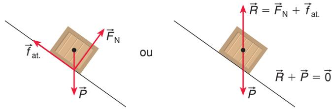
b) Estando a caixa em repouso, a intensidade da força resultante na direção do plano de apoio é nula.
