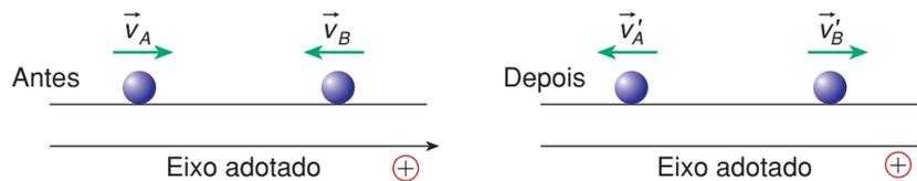
$$Q_{\text{antes}} = m_A \cdot v_A - m_B \cdot v_B \text{ e } Q_{\text{depois}} = -m_A \cdot v'_A + m_B \cdot v'_B$$
