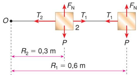
$$\text{Corpo 1: } T_1 = m\omega^2 R_1 \Rightarrow T_1 = 0,2 \cdot 4^2 \cdot 0,6 \Rightarrow T_1 = 1,92 \text{ N}$$
