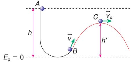
Ao atingir o ponto C, a esfera possui velocidade  $v_x$  na direção horizontal e, portanto, energia cinética não nula. A energia mecânica no ponto C será dada por:
