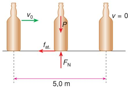
$$f_{\text{at.}} = ma \Rightarrow \mu \cdot F_N = ma \Rightarrow \mu \cdot mg = ma \Rightarrow a = \mu g \Rightarrow a = 0,16 \cdot 10,0 \Rightarrow a = 1,6 \text{ m/s}^2$$
