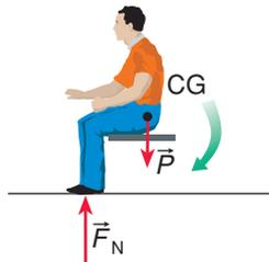
Quando a pessoa tende a se levantar, ela perde contato com a cadeira, e a reta vertical em seu centro de gravidade não passa pela base de apoio, que são seus pés. Nessas condições, o momento do peso  $\vec{P}$  em relação ao ponto de apoio (pés da pessoa) faz com que ela volte à posição original, sem conseguir levantar-se.
