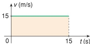
$$\Delta s_B = 15 \text{ m/s} \cdot 15 \text{ s} = 225 \text{ m}$$
