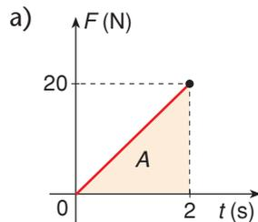
O módulo do impulso é dado numericamente pela área destacada no gráfico:
