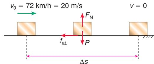
P.270  $f_{\text{at.}} = \mu_d \cdot F_N \Rightarrow f_{\text{at.}} = 0,6 \cdot 100 \Rightarrow f_{\text{at.}} = 60 \text{ N}$
