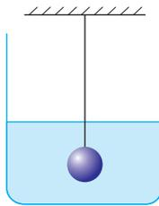
O líquido exerce na esfera uma força  $\vec{E}$  (vertical e para cima). Pelo princípio da ação e reação, a esfera exerce no líquido uma força  $-\vec{E}$  (vertical e para baixo). É essa força que provoca o acréscimo de pressão  $\Delta p$  no fundo do recipiente:
