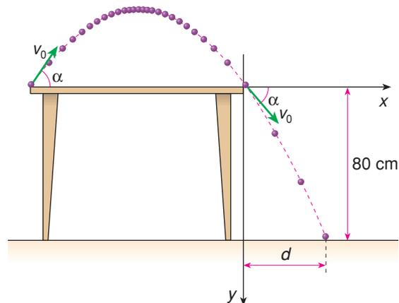
$$\begin{cases} v_{0y} = v_0 \cdot \sin \alpha = 5,00 \cdot 0,60 \Rightarrow v_{0y} = 3,0 \text{ m/s} \\ v_x = v_0 \cdot \cos \alpha = 5,00 \cdot 0,80 \Rightarrow v_x = 4,0 \text{ m/s} \end{cases}$$
