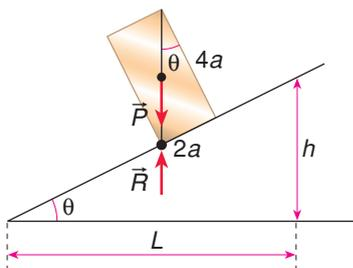
Como  $\text{tg } \theta = \frac{h}{L}$ , temos:  $\frac{h}{L} = 0,8$  (condição correspondente à iminência de deslizamento)
