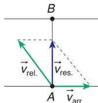
$$a) \Delta t = \frac{AB}{|\vec{v}_{rel.}|} = \frac{0,8 \text{ km}}{4 \text{ km/h}} = 0,2 \text{ h} \Rightarrow$$
