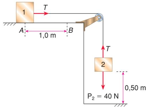
Cálculo da aceleração dos blocos até o bloco 2 atingir o solo:
