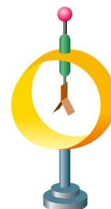
Figura 18. Eletroscópio de folhas.
