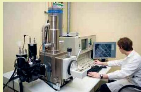
Microscópio eletrônico de varredura.
