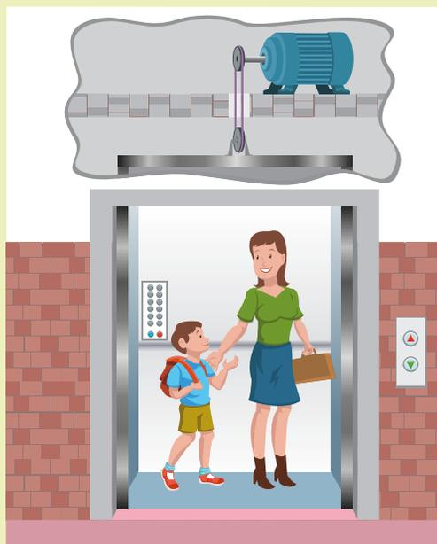
Figura c. No elevador, o motor elétrico puxa o cabo de sustentação através de uma polia, fazendo-o subir ou descer.
