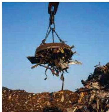
Figura 33. Uso de eletroímã para levantar sucata de ferro.
