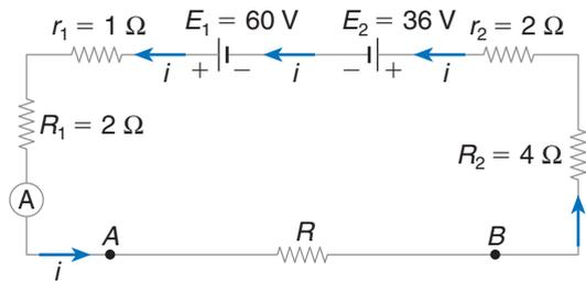
$E_1 = 60 \text{ V}$  é o gerador e  $E_2 = 36 \text{ V}$ , o receptor. Pela lei de Pouillet:
