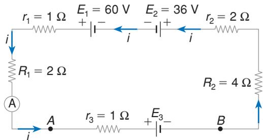
$E_1 = 60 \text{ V}$  é o gerador,  $E_2 = 36 \text{ V}$  e  $E_3$  são receptores. Pela lei de Pouillet:
