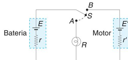
b) Com a chave S em B e aplicando novamente a lei de Pouillet:
