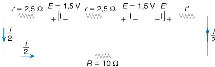
$$\frac{i}{2} = \frac{E + E - E'}{R + r + r + r'} \Rightarrow \frac{0,2}{2} = \frac{1,5 + 1,5 - E'}{10 + 2,5 + 2,5 + r'} \Rightarrow 0,1 = \frac{3,0 - E'}{15 + r'} \quad \textcircled{2}$$
