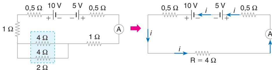
O elemento de 10 V é o gerador. O sentido da corrente é do polo negativo para o polo positivo. Nessas condições, o sentido da corrente no elemento de 5 V é do polo positivo para o negativo e ele funciona como receptor.
