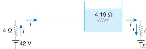
I. Impedindo a rotação do motor, tem-se  $E' = 0$ .
