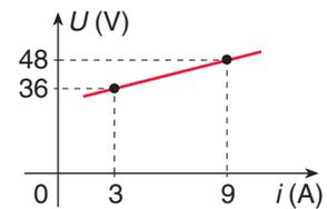
b) A potência elétrica fornecida ao receptor, isto é, a potência elétrica que o receptor consome, é dada por:
