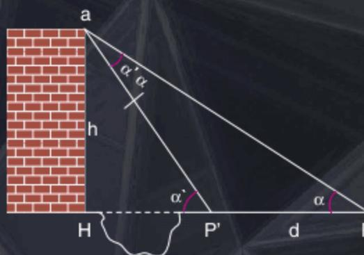
Cálculo da altura de uma torre visível, mas não acessível devido a uma depressão entre H e P'.
