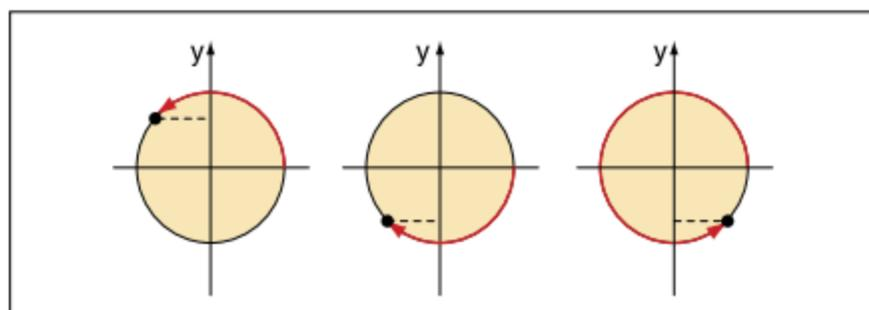
Fig. 3 Construção geométrica do seno.
