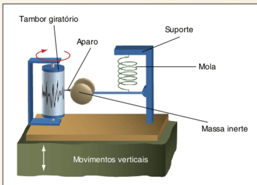
Exemplo básico do funcionamento de um sismógrafo.
