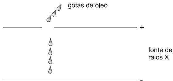
Inicialmente, observa-se a queda de uma gotícula de óleo entre as placas unicamente sob a ação da gravidade e, pela medida da velocidade da queda, calcula-se a massa. Durante a queda dessa gotícula, liga-se a fonte de raios X, que liberará elétrons das moléculas do ar.
