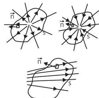
Fluxo elétrico através de uma superfície fechada **S**, em três casos: as linhas de força saem da superfície, e o fluxo é positivo (a); as linhas de força entram na superfície e o fluxo é negativo (b); as linhas de força apenas atravessam a superfície (entram e saem) e o fluxo é nulo (c).
