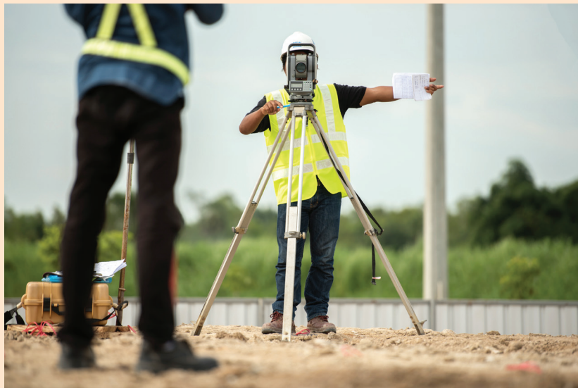
Teodolito, usado para medir ângulos em trabalhos topográficos.
