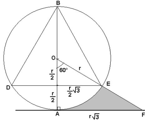
A rotação de AEF em torno do eixo AB gera um sólido cujo volume é dado pela retirada de uma calota esférica (altura  $r/2$  e raio da seção  $r\sqrt{3}/2$ ), de um tronco de cone (altura  $r/2$  e raios de base  $r\sqrt{3}/2$  e  $r\sqrt{3}$ ).
