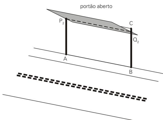
O portão, que tem 3 m de altura, sobe e simultaneamente gira 60 graus em torno desse eixo, até ficar totalmente aberto, suspenso nas posições indicadas por  $P_2$  e  $Q_2$ .
