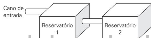
A água entra no sistema pelo cano de entrada do Reservatório 1 a uma vazão constante e, ao atingir o nível do cano de ligação, passa a abastecer o Reservatório 2. Suponha que, inicialmente, os dois reservatórios estejam vazios.
