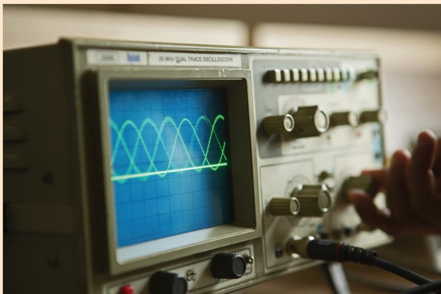
A corrente alternada pode ser descrita por funções trigonométricas. Na imagem, vemos a superposição de senóides em um osciloscópio.
