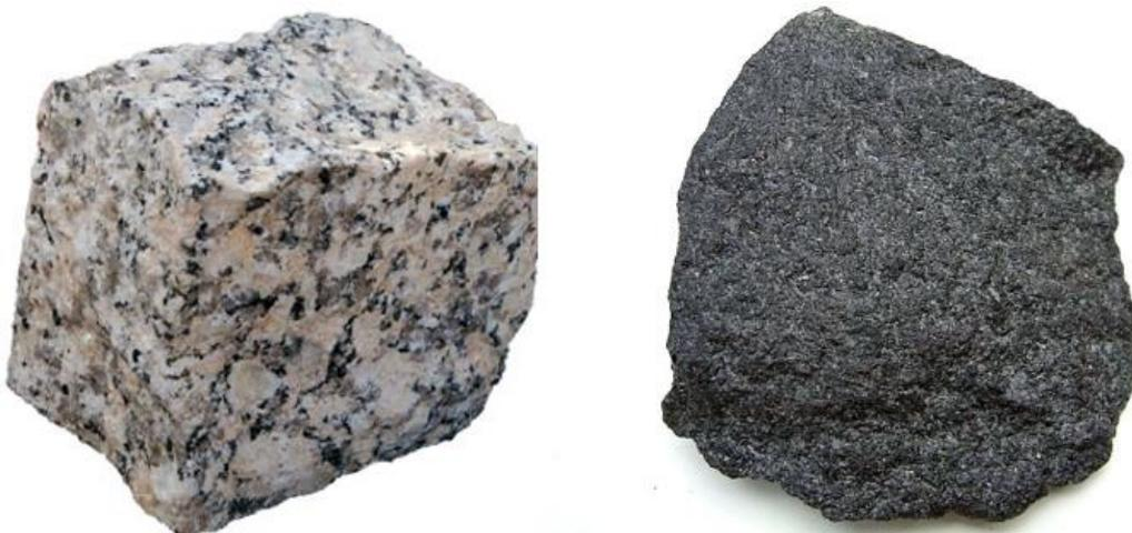
Figura 54 – Granito (à esquerda) e Basalto (à direita)
