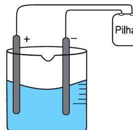
Usaram-se como eletrodo dois bastões de grafite, uma solução aquosa  $1,0 \text{ mol}\cdot\text{L}^{-1}$  de  $\text{CuSO}_4$  em meio ácido a  $20^\circ\text{C}$  e uma pilha.
