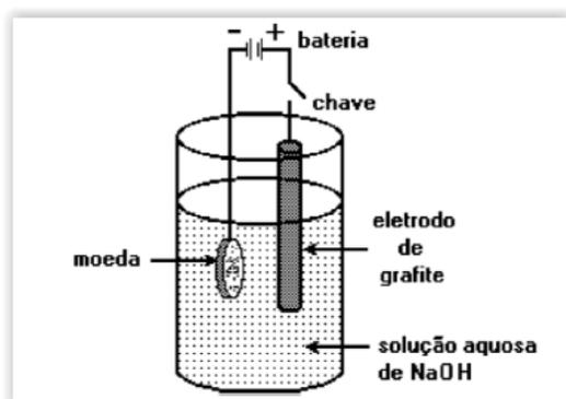
Quando a chave for ligada, ocorrerá o processo de redução do íon Cu<sup>2+</sup>. Uma corrente de 20 A passará pela solução durante 965 segundos. Durante esse tempo, haverá depósito de cobre sobre a moeda.
