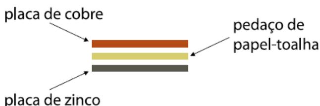
Utilizando três pilhas ligadas em série, o aluno montou o circuito elétrico esquematizado, a fim de produzir corrente elétrica a partir de reações químicas e acender uma lâmpada.
