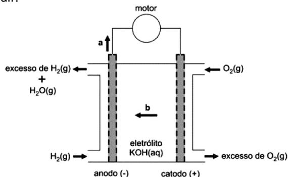
Escrevendo as equações das semirreações que ocorrem nessas pilhas de combustível, verifica-se que, nesse esquema, as setas com as letras **a** e **b** indicam, respectivamente, o sentido de movimento dos
