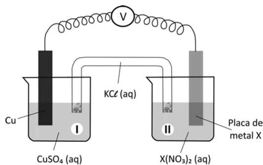
Nessas três montagens, o conteúdo do béquer I era uma solução aquosa de  $\text{CuSO}_4$  de mesma concentração, e essa solução era renovada na construção de cada pilha. O eletrodo onde ocorria a redução (ganho de elétrons) era o formado pela placa de cobre mergulhada em  $\text{CuSO}_4$  (aq). Em cada uma das três pilhas, o estudante utilizou, no béquer II, uma placa de um dos metais X (Pb, Zn ou Fe), mergulhada na solução aquosa de seu respectivo nitrato.
