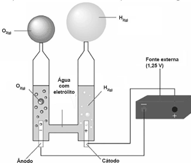
A eletrólise da água ocorre quando uma corrente contínua passa por ela. Como a água pura não conduz corrente elétrica, a adição de um eletrólito torna-a condutora e possibilita a realização do processo. Porém, quando se trata de produção de gás hidrogênio ( $\text{H}_2$ ), não é todo eletrólito que pode ser utilizado.
