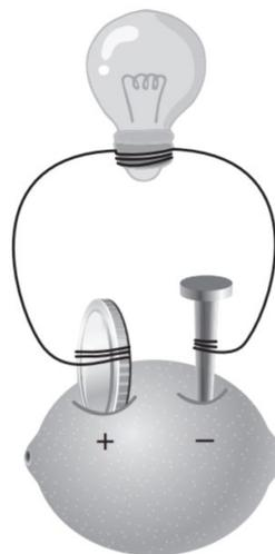
Nessa montagem, os eletrodos podem ser conectados a uma lâmpada LED, que acende com a passagem de corrente elétrica.
