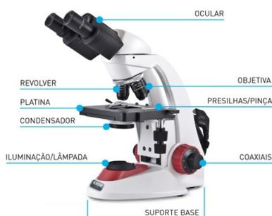
**Microscópio óptico binocular. Platina é o suporte para o espécime a ser observado, funcionando como uma mesa móvel para que se possa selecionar a parte do espécime que se deseja observar.**
