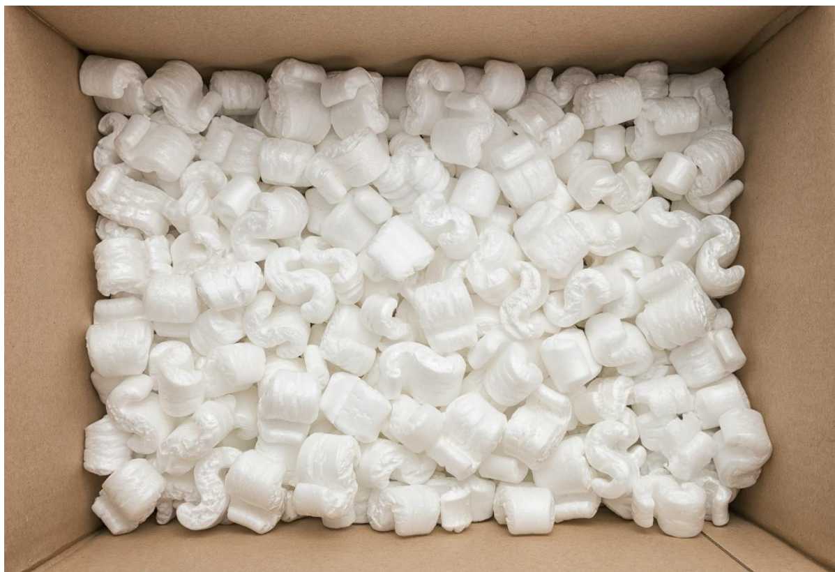
Figura 16: Isopor utilizado como barreira mecânica para o transporte de equipamentos
