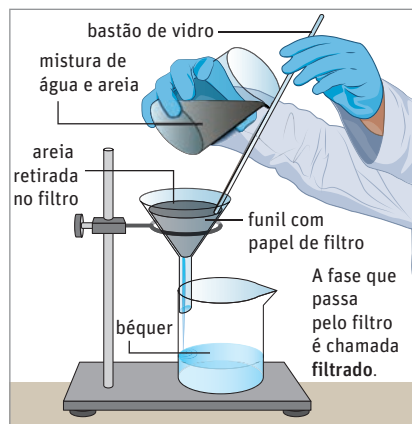
Aparelhagem usada em laboratório para filtração comum. Esquema fora de proporção e em cores-fantasia.
