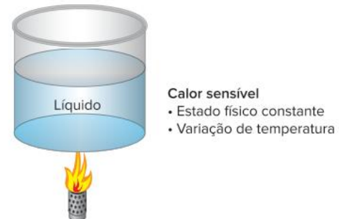
Fig. 3 Calor sensível implica apenas variação de temperatura.
