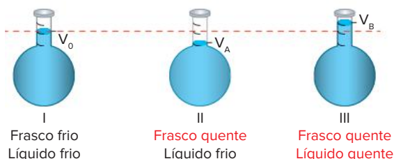
Fig. 9 Dilatação aparente de líquidos.
