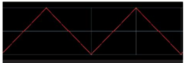
Fig. 22 Representação da forma de onda da corrente alternada triangular.
