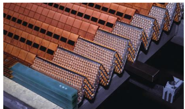
Parte dos sensores para a detecção de partículas em um calorímetro.
