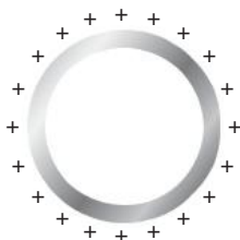
Fig. 17 Distribuio de cargas em um condutor esférico em equilíbrio eletrostático.
