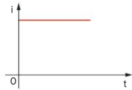
Fig. 16 Forma de onda da corrente contínua.
