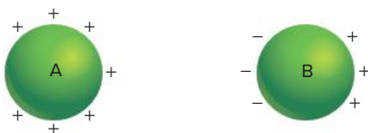
Fig. 20 Indução do corpo condutor B por um corpo A positivamente carregado.
