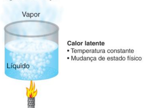
Fig. 4 Calor latente implica apenas mudança de estado físico.
