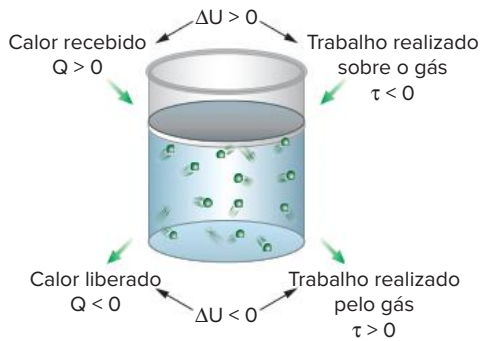
Fig. 23 Alteração da energia interna ( U ) de um sistema gasoso com calor ( Q ) e trabalho ( \tau ).
