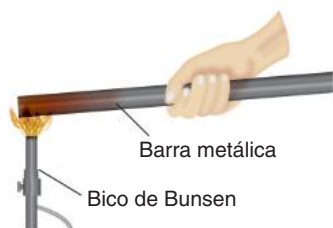
Fig. 1 A condução é o transporte de energia sem transporte de matéria.
