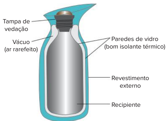
Fig. 19 Esquema de uma garrafa térmica.
