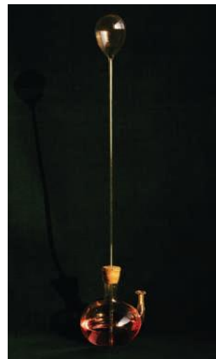
Fig. 11 Termoscópio de Galileu, 1592.
