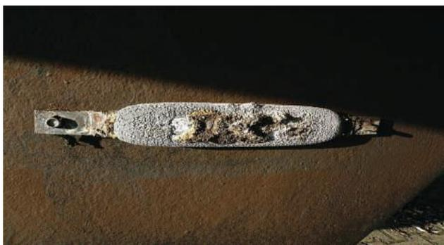
Magnésio metálico parcialmente corroído, sendo utilizado como metal de sacrifício em casco de navio.
