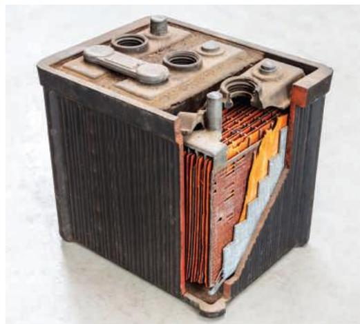
Bateria de carro parcialmente aberta, mostrando as placas de Pb intercaladas com placas de  $\text{PbO}_2$ . Há seis células em série, totalizando 12 V.
