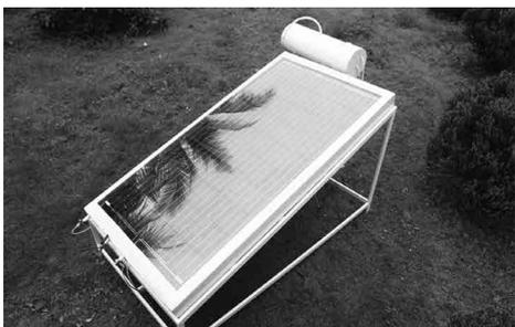
De acordo com os criadores, em 8 horas de trabalho diário da máquina, é possível dessalinizar 5 litros de água por dia, que podem ser consumidos imediatamente, sem a necessidade de filtros ou elementos químicos para a retirada de poluentes.
