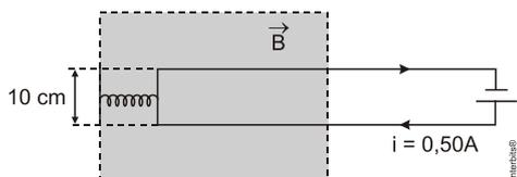
Inicialmente não há corrente na espira e a mola não está distendida nem comprimida. Quando uma corrente elétrica de intensidade  $i = 0,50 \text{ A}$  percorre a espira, no sentido horário, ela se move e desloca de  $1,0 \text{ cm}$  a extremidade móvel da mola para a direita. Determine o módulo e o sentido do campo magnético.
