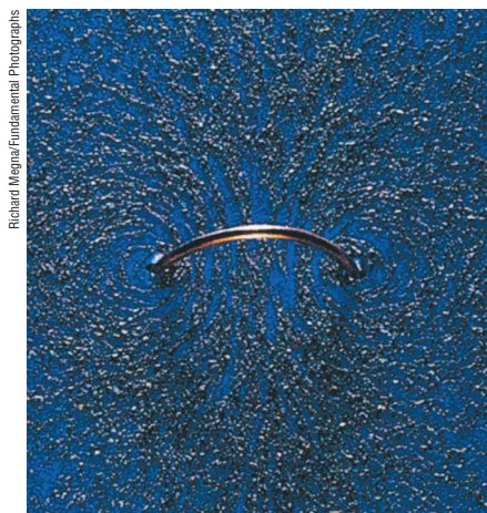
Padrão obtido com limalha de ferro, do campo magnético gerado pela corrente elétrica em uma espira circular.
