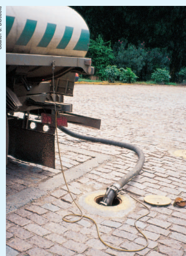
Os caminhões que transportam combustíveis precisam ter o tanque aterrado.
