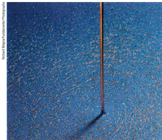
Padrão do campo magnético gerado pela corrente elétrica em um fio retilíneo. Cada partícula de ferro comporta-se como uma minúscula agulha imantada.
