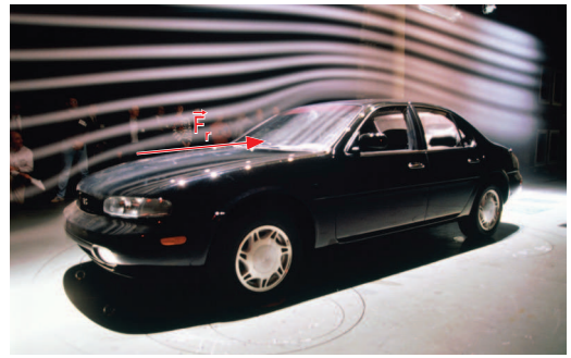
Teste de um carro em túnel de vento.
