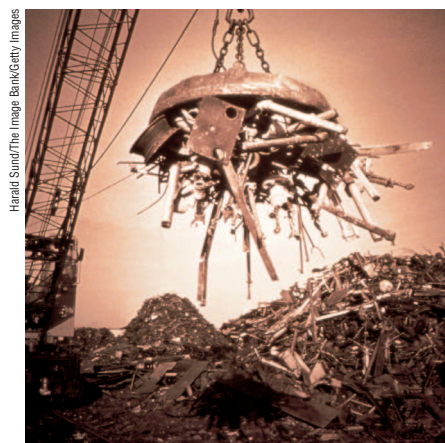
O guindaste eletromagnético retira da sucata os materiais ferromagnéticos.
