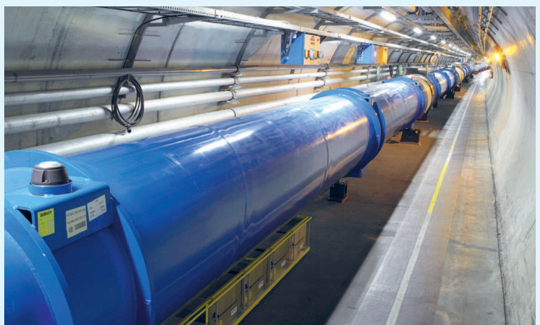
Interior do acelerador de partículas LHC – nesse tubo de 27 km de extensão, partículas subatômicas são aceleradas a 99,9% da velocidade da luz.
