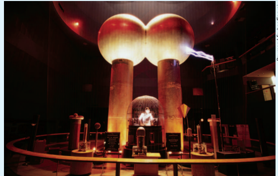
Moderno gerador eletrostático do tipo Van de Graaff, que pode produzir milhões de volts.
